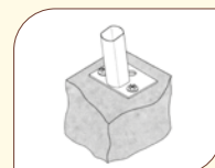
Plattenverankerung
